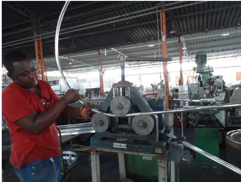
FIGURA 91: processo de fabricação da poltrona Cariri. FONTE: figura cedida por Sérgio Matos.
