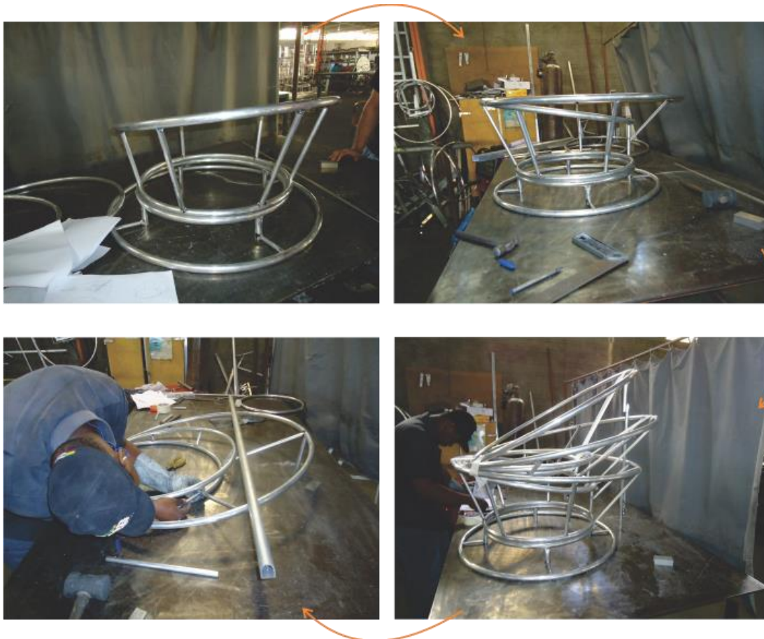
FIGURA 92: simplificação do processo de montagem poltrona Cariri. FONTE: figura cedida por Sérgio Matos.
