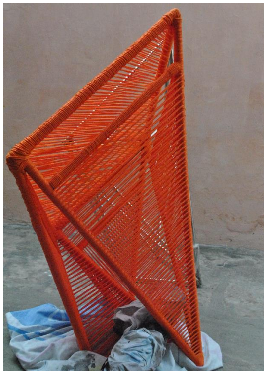
FIGURA 82: vista lateral do espaldar da poltrona Balão já revestido. FONTE: acervo do autor da pesquisa.
