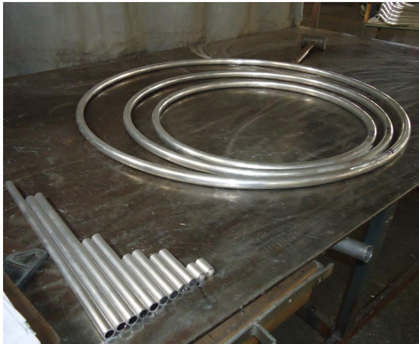
FIGURA 90: módulos circulares e elementos de ligação. FONTE: acervo do autor da pesquisa.
