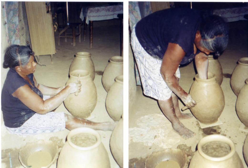
**Figura 69:** Uso do cascabelho para garantir firmeza ao pote. Povoado de Nova União, em 2003.
