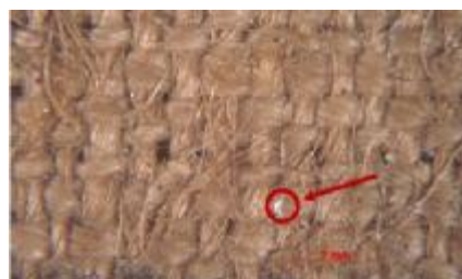
Amostra 2306T imagem com Aumento 18x, indicando presença de adesivo
