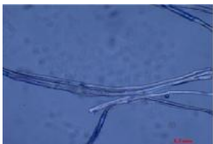
Dispersão da amostra 2305T. Aumento 33x (fibra vertical)
